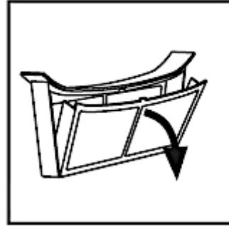
4. Reinigen Sie das Flusensieb. Entfernen Sie die Rückstände mit einem feuchten Tuch.
