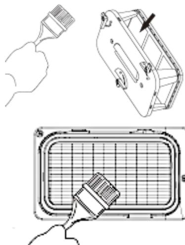
4. Reinstallieren Sie den Kondensator ordnungsgemäß und schließen Sie die Verriegelungen. **Der Kondensator muss vor der Reinstallation komplett trocken sein.**
