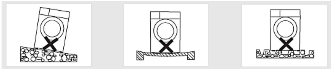
11. Kippen Sie das Gerät nicht über einen Winkel von 45° hinaus. Lassen Sie das Gerät für **mindestens 3 Stunden** aufrecht stehen, bevor Sie es an die Stromversorgung anschließen.
