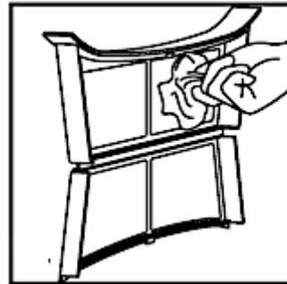
6. Setzen Sie das Flusensieb wieder ordnungsgemäß ein; **das Flusensieb muss komplett trocken sein.**
