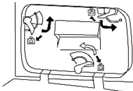
3. Entfernen Sie die Flusen. Reinigen Sie den Kondensator vorsichtig mit Hilfe einer sauberen Bürste.
