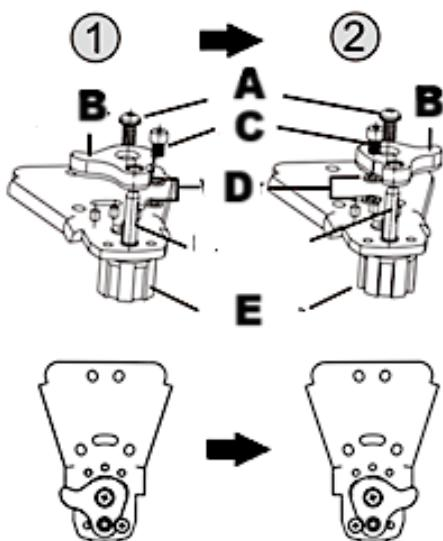
10. Entfernen Sie die drei Schrauben, mit denen die untere Scharniereinheit befestigt ist, und nehmen Sie die untere Scharniereinheit ab (s. Abb. links, 1).
