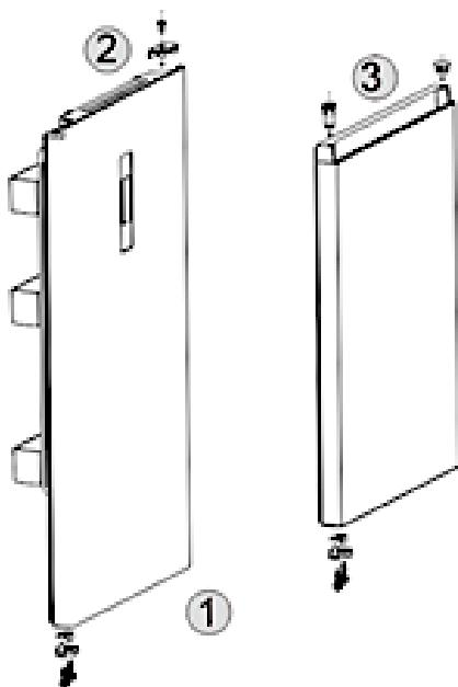
14. Bringen Sie die montierte untere Scharnierbaugruppe auf der linken unteren Seite des Gerätes an (s. Abb. links, 1).
