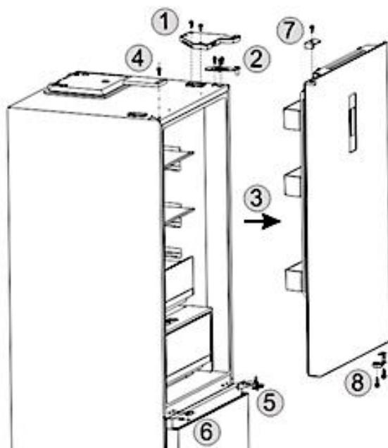
1. Schrauben Sie die obere Türscharnierabdeckung ab und entnehmen Sie das Türscharnier (s. Abb. links, 1).
