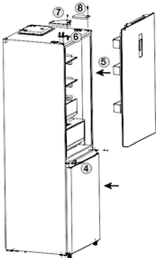
19. Installieren Sie die Gefrierschranktür am Gerät, nehmen Sie das linke mittlere Scharnier aus dem Zubehörbeutel und befestigen Sie es mit zwei Bolzen und einer Schraube am Gerät (s. Abb. links, 4).
