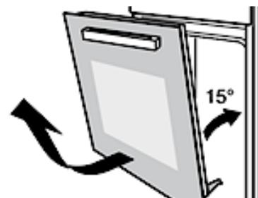
4. Um die Tür wieder einzusetzen, verfahren Sie in umgekehrter Reihenfolge.
