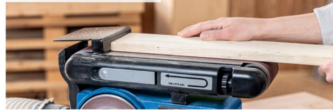
Le disque de ponçage est intégré dans le bâti de la ponceuse permettant ainsi de poncer de grandes pièces.
