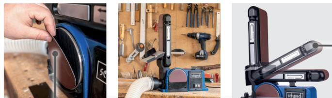
Bande de ponçage positionnable à l'horizontale et à la verticale
