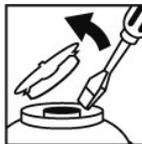
Entfernen Sie die Sprühsicherung indem Sie zuerst den
