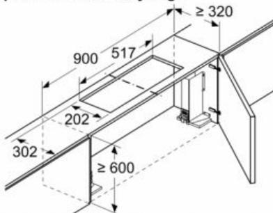
L'utilisation d'un kit de recyclage n'est pas possible pour les armoires avec barre transversale (porte à soulever)
