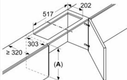
L'utilisation d'un kit de recyclage n'est pas possible pour les armoires avec barre transversale (porte à soulever)
