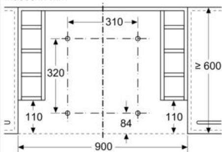
Montage Flachschriftmaube mit Absenkrahmen
