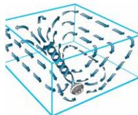
Le circuit d'air provenant des protections en spirale, peut atteindre une distance jusqu'à 30 m (Dépendant le model). Le circuit d'air est de caractère dense.
