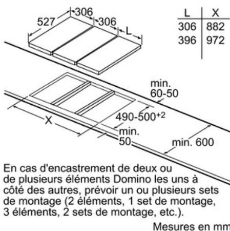
Image se rapportant au tableau des possibilités de combinaisons Domino avec dimensions appareils et découpes pour montage correspondantes
