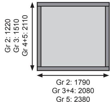
Fundamentplan (in mm) bei Aufbau mit Fußboden:
