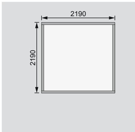
**Fundamentplan mit Boden (in mm)**
