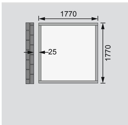
**Fundamentplan mit Boden (in mm)**
