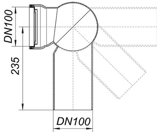
ohne Achsenversatz stufenlos verstellbar von 0 – 90 Grad
