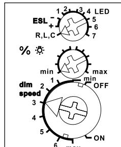
Unter dem oberen Drehschalter auf der Frontseite befindet sich eine LED, welche eine Ansteuerung anzeigen. Sie beginnt nach 15 Sekunden zu blinken, um auf einen möglicherweise blockierten Steuertaster aufmerksam zu machen.
