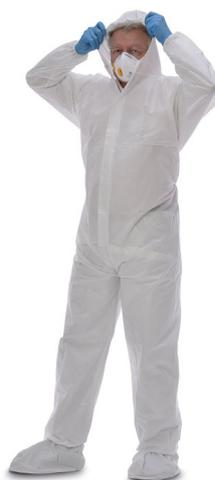
**Description :** Combinaison de protection une pièce en non-tissé SMS 55 g/m<sup>2</sup>, avec capuche, fermeture à glissière ouvrant sur le devant recouverte d'un rabat auto-adhésif, élastique au niveau des manchettes, des chevilles, de la capuche et de la taille, coutures ourlées.
