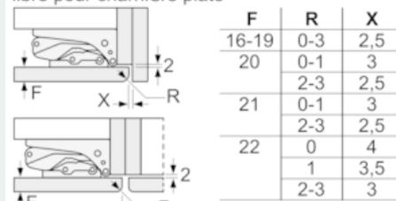
Les dimensions d'espace libre recommandées dans le tableau doivent être respectées afin d'assurer une ouverture sans collision des portes de l'appareil, et d'éviter ainsi d'endommager les meubles de cuisine.
