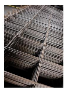
Baustahlmatten sind Gitter aus verschweißten Betonstahlstäben, welche zur Bewehrung von flächigen Stahlbetonbauteilen wie zum Beispiel Bodenplatten, Decken oder Wänden dienen.
