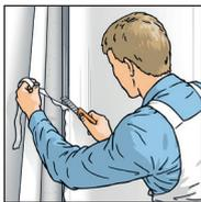
**6.** Dans les coins et sur les arêtes, ne pas effectuer de chevauchement. La séparation se fait exactement sur l'arête. Tapisser les deux lés bord à bord à joints vifs.
