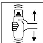
Après le déclenchement, bien agiter l'aérosol à nouveau durant 2 minutes à compter du bruit clair des billes mélangeuse. Puis laisser reposer l'aérosol 15 minutes.
