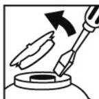
Retirez la bague de protection en retirant dans un premier temps le diffuseur. Utilisez un tournevis plat entre la languette et le clips. Avec un mouvement vers le bas, dégagez doucement la bague de protection.
