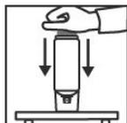
Placer l'aérosol muni du capuchon sur un support fixe, tête en haut. Appuyer à fond avec la main sur le percuteur blanc.
