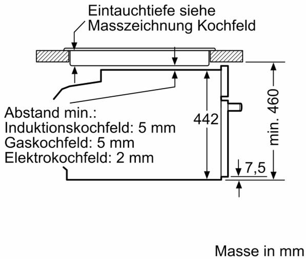
Wird das Kompaktgerät unter einem Kochfeld eingebaut, muss folgende Arbeitsplattenstärke (ggf. inkl. Unterkonstruktion) beachtet werden.
