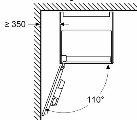
En cas d'utilisation du limiteur de charnière à  $92^\circ$ , la distance min. au mur est uniquement de 100 mm
