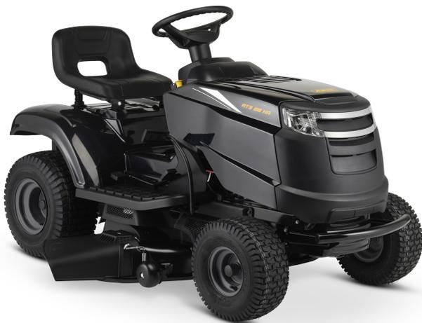
**Cette autoportée de 98 cm de coupe peut éjecter latéralement ou faire du mulching et dispose d'un entraînement hydrostatique à pédale. La puissance provient d'un moteur 414cc STIGA. Kit mulching disponible séparément.**
