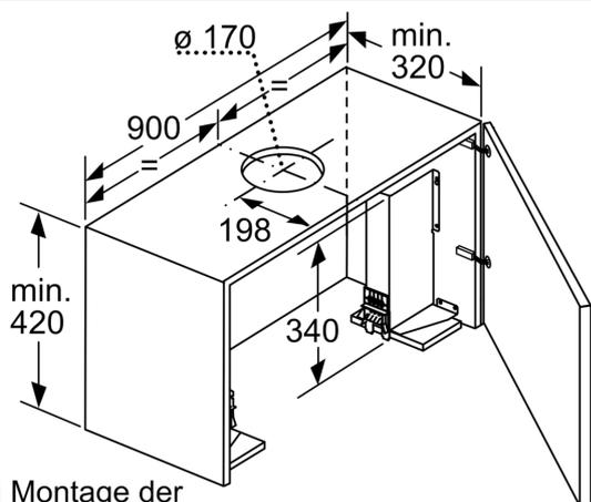
Bei Montage der 90cm Flachschrumbauhaube in einen 90cm breiten Oberschrank ist ein Montage-Set erforderlich. Die beiden Montagewinkel werden rechts und links im Möbel verschraubt. Montage nach Schablone. Masse in mm
